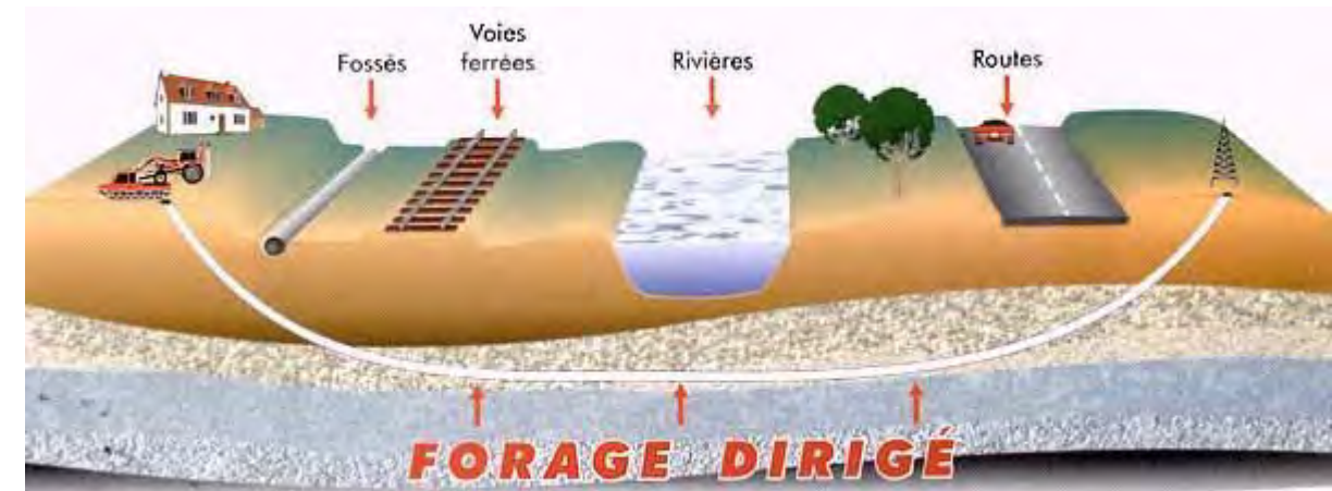
Figure 227 : Méthode du forage dirigé (Source : WikiTP)
