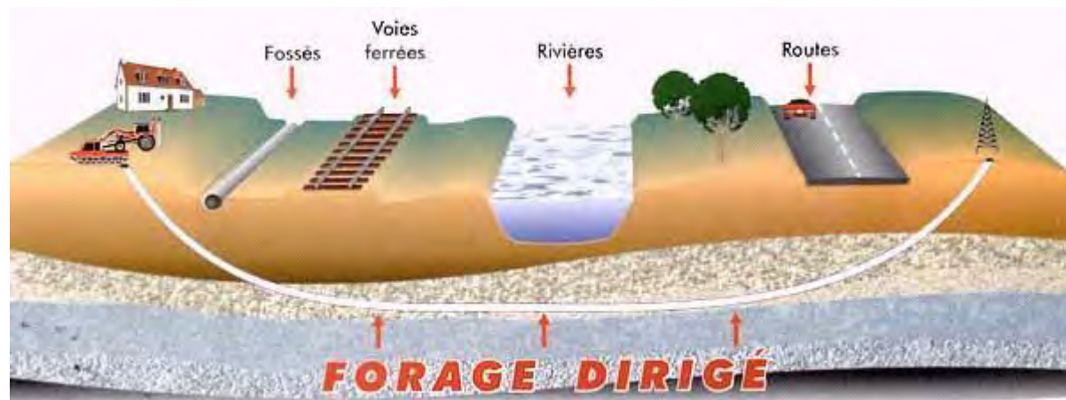
Figure 226 : Méthode du forage dirigé (Source : WikiTP)
