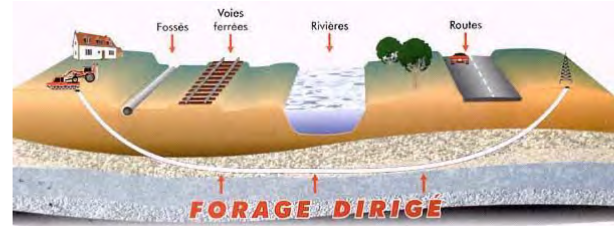
Figure 245 : Méthode du forage dirigé (Source : WikiTP)
